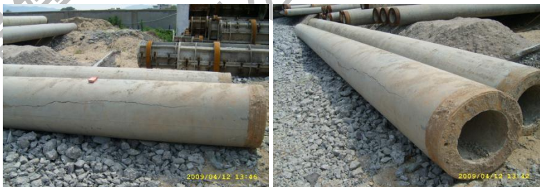
图 2 管桩穿越较厚淤泥桩身开裂(1) 图 3 管桩穿越较厚淤泥桩身开裂(2)
