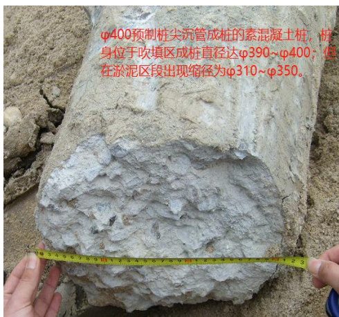
图1 沉管灌注桩穿越淤泥缩径明显
